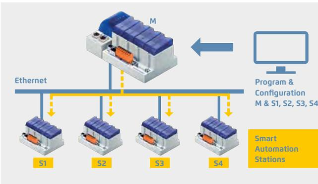
Die Anwendungsprogramme werden vom Smart Automation Manager zentral verwaltet und an die Smart RIOs verteilt. Bei einem Hardwaretausch werden die Programme und die Konfiguration automatisch neu geladen. Zur Speicherung der RIO-Programme muss der Manager über ausreichende Speicherressourcen verfügen. Dazu können der onboard Programmspeicher sowie die steckbaren Flashspeichermodule PCD7.Rxxx und PCD3.Rxxx verwendet werden.
