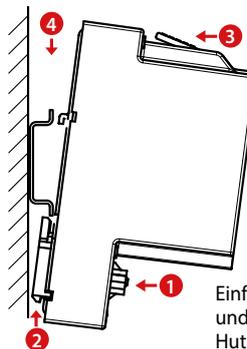
Einfache Montage der CPUs und Modulträger auf DIN-Hutschiene (1 x 35 mm)
