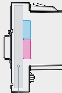
Die CPU ist in der Rückwand integriert. Auf der gleichen Fläche können somit noch 4 E/A-Module gesteckt werden.
