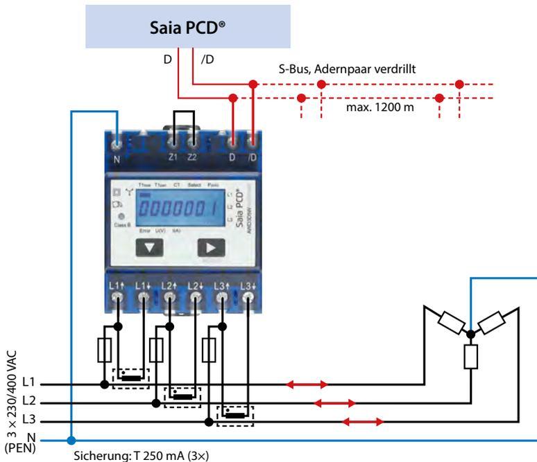
▲ Energiemessung beider Stromrichtungen mit einer Saia PCD zur Weiterverarbeitung der Messwerte
