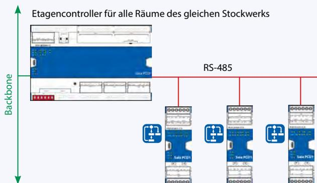
Alle Module sind frei programmierbar und «Stand alone» betreibbar. Ein Datenaustausch untereinander erfolgt über die RS-485 Verbindung und einer Kopfstation, beispielsweise einem Etagencontroller.
