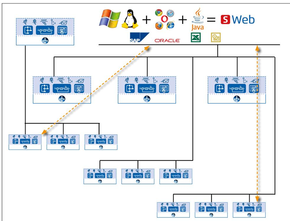
▶ Lean Automationssystem: alle Kernfunktionen der Automation (SPS+Web+IT) integriert in jedem Automationsgerät ermöglicht Integration und Interaktion aller Geräte von der Feld- bis zur Leitebene.
