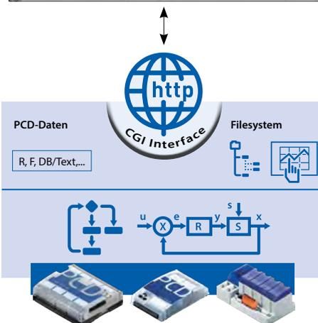
Mit Microsoft -Excel können direkt Saia PCD-Daten in eine Zelle eingekoppelt werden. Solange die EXCEL-Applikation läuft, werden die Daten aus der verbundenen Saia PCD permanent aktualisiert. Das alles ohne jede spezifische Treibersoftware/ Middleware wie bei anderen Systemen notwendig.
