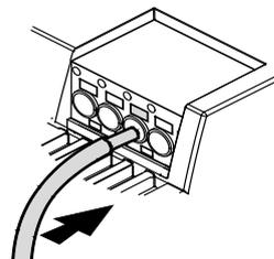
Querschnitt. Feindrähtige Leiter bis zu 2,5 mm<sup>2</sup> können aber auch direkt mit einfacher Drückerbetätigung (Schraubenzieher) angeschlossen werden.
