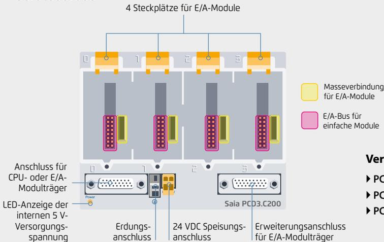
In den Erweiterungsmodulträgern können alle Standard-E/A-Module genutzt werden. Kommunikations- oder andere intelligente Module können nur in den Steckplätzen der Basis-CPU genutzt werden.
