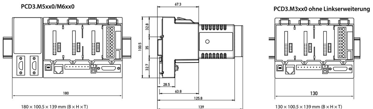
▲ Standard- und High-Power-CPU mit Steckplätzen für Batterie- und Speichermodule, Run-/Stop-Schalter und zusätzlichen Schnittstellen
