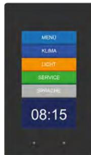
Die Lage des Panels kann die Temperaturmessung leicht beeinflussen. Eine einfache Kalibrierung ermöglicht es, dies zu beheben und erhöht so die Genauigkeit.
