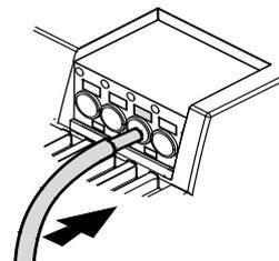
Querschnitt. Feindrätige Leiter bis zu 2,5 mm<sup>2</sup> können aber auch direkt mit einfacher Drückerbetätigung (Schraubenzieher) angeschlossen werden.
