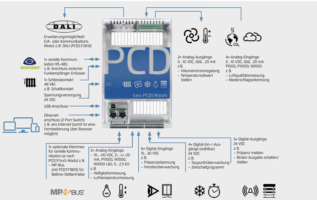
Beleuchtung, Sonnenschutz und Einzelraumregelung können mit diesem Controller optimal aufeinander abgestimmt werden. Angelehnt an Applikationen nach Raumautomations-Funktionsliste VDI 3813 und GA-Funktionsliste DIN EN 15232 zeigt das Beispiel eine mögliche Belegung.
