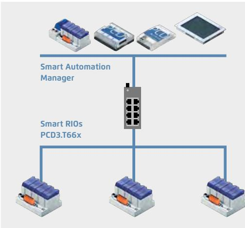
Als Smart Automation Manager können PCD1.M21x0-, PCD2.M5-, PCD3.M3/5/6-CPU's sowie die programmierbaren Micro-Browser-Panel PCD7.D4xxxT5F verwendet werden
