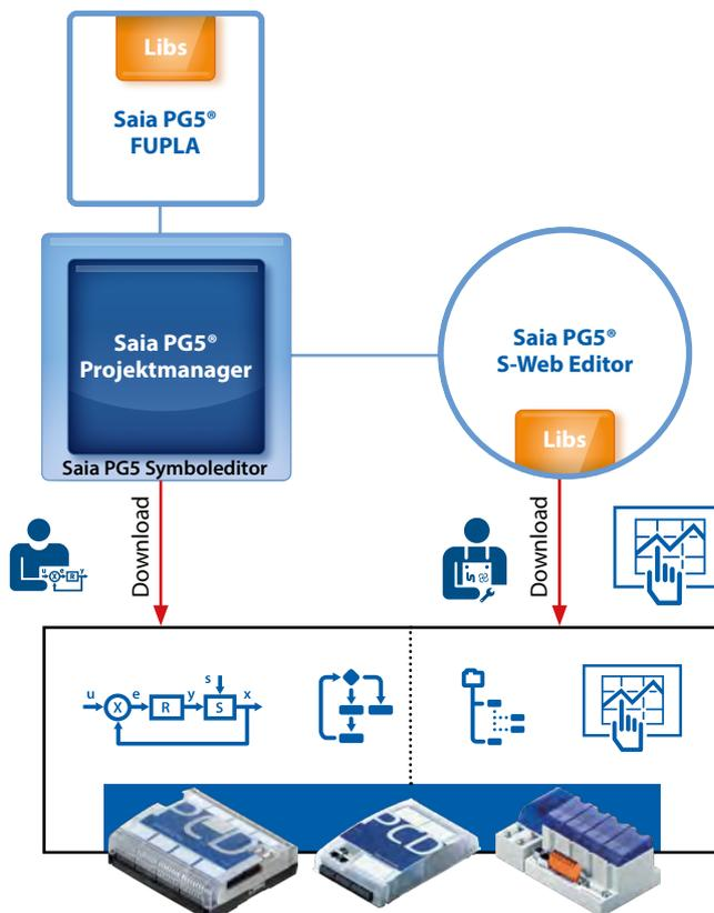
▲ MSR- und Web HMI Applikation können unabhängig von einander in die PCD Steuerung geladen werden
