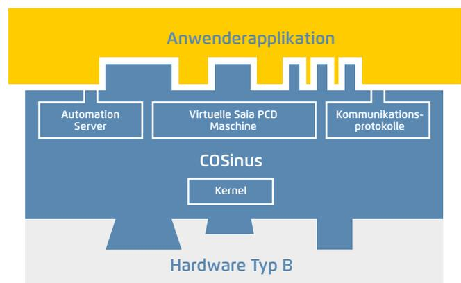
▲ Das Betriebssystem COSinus stellt der Applikation immer die gleiche Infrastruktur zur Verfügung, unabhängig davon, wie die darunter liegende Hardware und der Prozessor aussehen. Der Schlüssel dafür ist die Saia Virtuelle Maschine. Sie sorgt dafür, dass ein mit PG5 erstelltes Applikationsprogramm bei allen PCDs über Generationen hinweg funktioniert.
