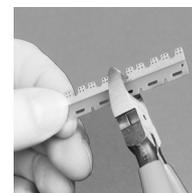
Die benötigte Anzahl an Kontakten mit einem Seitenschneider an der entsprechenden Sollschnittstelle abschneiden. Dann die Durchschaltbrücke von oben in den Kontaktschlitz einsetzen und herunterdrücken.
