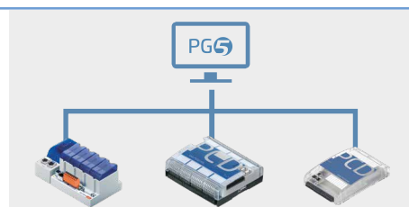
Accès avec l'appareil de programmation via interface série, Ethernet ou USB
