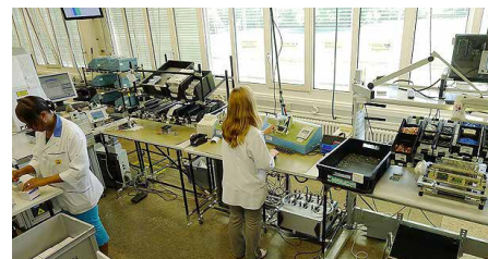
▲ Cellule de production de compteurs d'énergie
