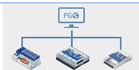
Zugriff mit dem Programmiergerät über Ethernet, USB oder serielle Schnittstelle
