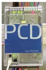
Utilizzo come interfaccia di comunicazione con M-Bus in una rete di teleriscaldamento
