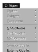
Cette étape est assurée par la fonction «Insertion, Source externe» du logiciel de programmation STEP®7 de Siemens®. Puis, avec la fonction «Edition, Compiler», les blocs de données contenant les pages HTML et images mémorisées sont intégrées par STEP®7 dans le programme utilisateur.
