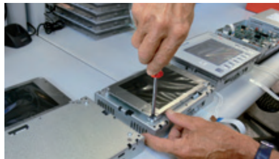
Handmontage von Panels
