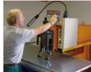
Blechbearbeitung der Montageplatten mit hydraulischer Stanze und CNC-Vermessung
