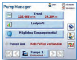
▲ KSB PumpManager basierend auf SBC Funktions-PCD ist auch freiprogrammierbar mit Step7 von Siemens.
