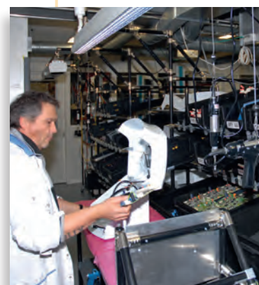
▲ Montagelinie System- und Energiemanager für das Micro KWK-System Vaillant/Honda: Auf der eigens für dieses Produkt erstellten Produktionslinie werden die SBC Boards nach Lean-Methoden montiert und getestet
