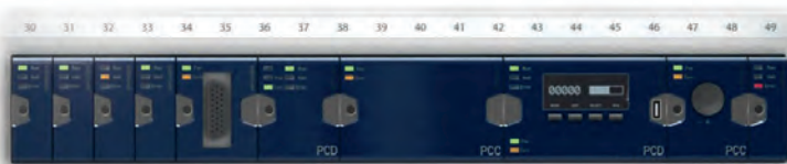
▲ Designstudie – SBC E-Line Produkte im Elektro-schaltschrank 17,5, 35, 70 oder 105 mm Baubreite
