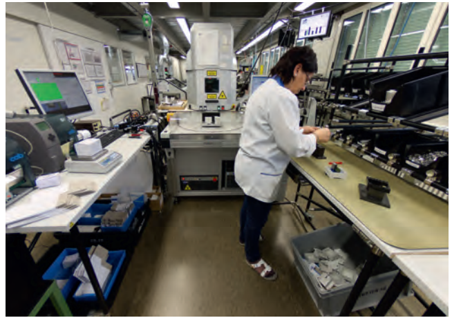
Dieselbe Produktion als «Lean» realisiert: Eine Person erstellt in wenigen Minuten ein komplettes Produkt – von der Bestückung der Leiterplatte bis hin zu versandfertig verpackt.
