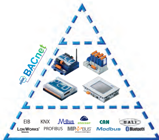
▲ Vielfalt: Je mehr Bus-Systeme im Feld, desto höher die Flexibilität und Funktionalität – jedoch überproportionaler Anstieg der Komplexität des Gesamtsystems!
