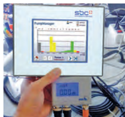
▲ SBC Funktions HMI als KSB PumpManager mit dem KSB PumpMeter im Entwicklungszentrum von KSB
