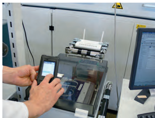
▲ Produktionsstätte: Betriebsdatenerfassung mit Hilfe von iPod
