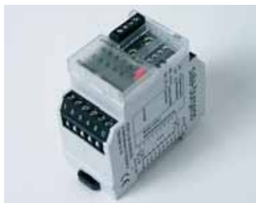
Module avec 10 entrées digitales. Type PCD7.L130
