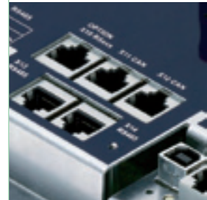
Version OEM du Saia®PCD3: tous les capteurs et actionneurs utilisés par le passé dans divers types de machines peuvent être raccordés sur CAN avec des fonctions et connexions compatibles.
