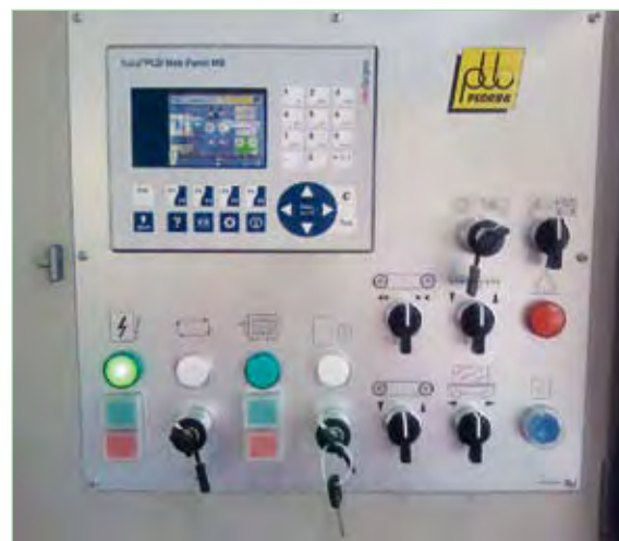
IHM de la nouvelle machine avec pupitre web Saia® de 3,5 pouces
