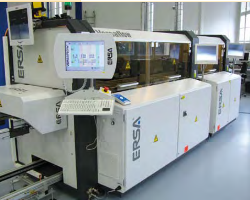
Nouvelle machine à souder sélective destinée aux Saia®PCD
