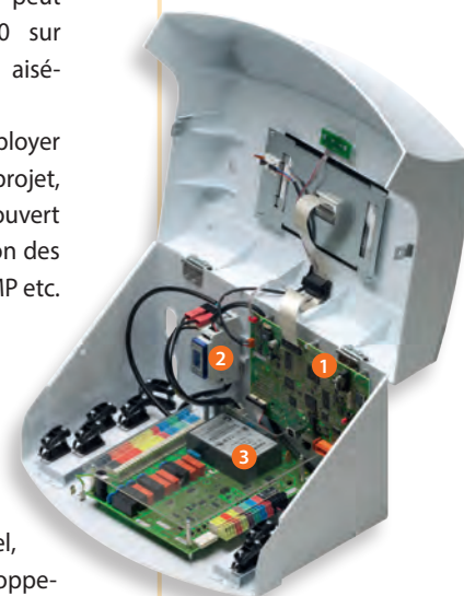
1 Carte mère Saia PCD® standard 2 Compteur d'énergie monophasé SBC 3 Carte E/S spécifique Vaillant
