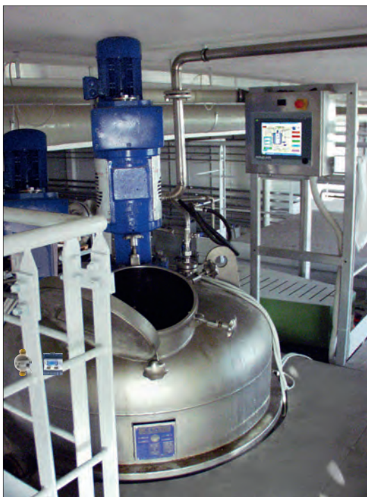
▲ Réacteur chimique avec IHM WEB
