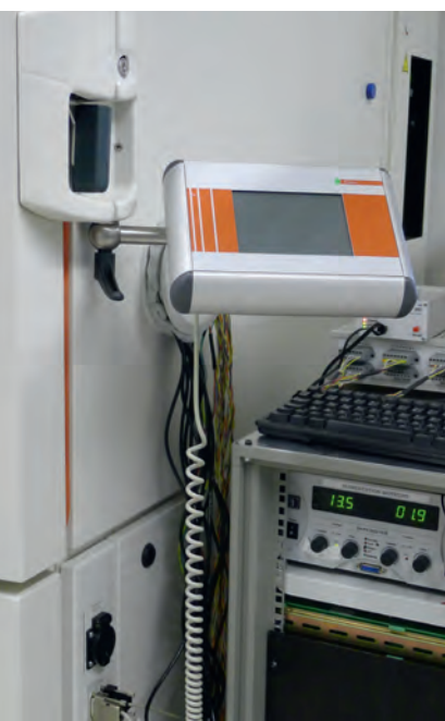
▲ Systèmes de montage onéreux pour pouvoir lire correctement les pupitres malgré une technologie LCD STN « bon marché ». La voie n'est pas encore dégagée de tout obstacle...
