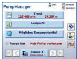
▲ Le KSB Pumpmanager basé sur le PCD fonctionnel SBC est également librement programmable avec Step7 de Siemens.
