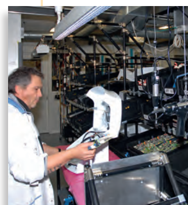
▲ Chaîne de montage du gestionnaire du système et d'énergie pour le système de micro-cogénération Vaillant/Honda : les modules SBC sont montés et testés selon les méthodes Lean sur la chaîne de production spécialement conçue pour ce produit.
