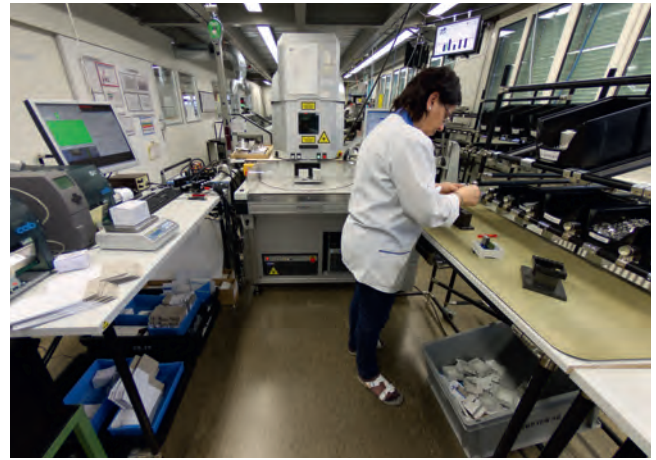
La même production mise en œuvre sous « Lean » : une personne crée un produit complet en quelques minutes – de l'équipement du circuit imprimé jusqu'à l'emballage prêt à l'expédition.
