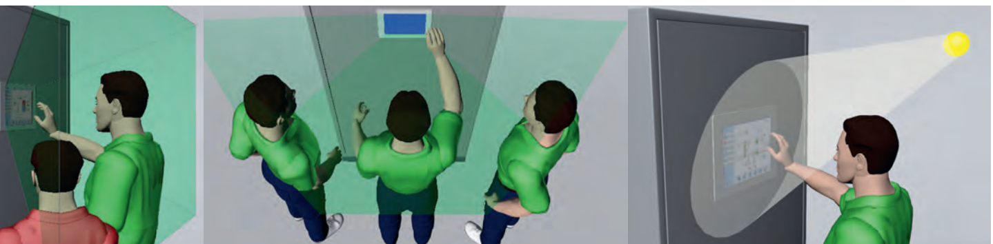
▲ Caractéristiques des LCD TFT : une bonne lisibilité à partir de n'importe quel angle de vision et des images précises, même par fort éclairage ambiant.
