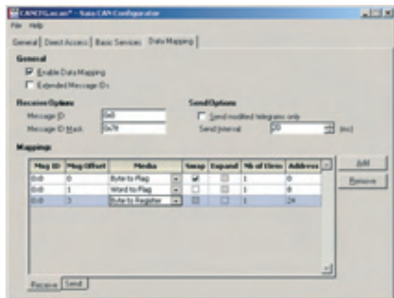
Configurazione CAN con Saia®PG 5 Controls Suite
