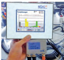
▲ SBC HMI Funzionale impiegato come KSB PumpManager con KSB PumpMeter nel centro di ricerca e sviluppo di KSB
