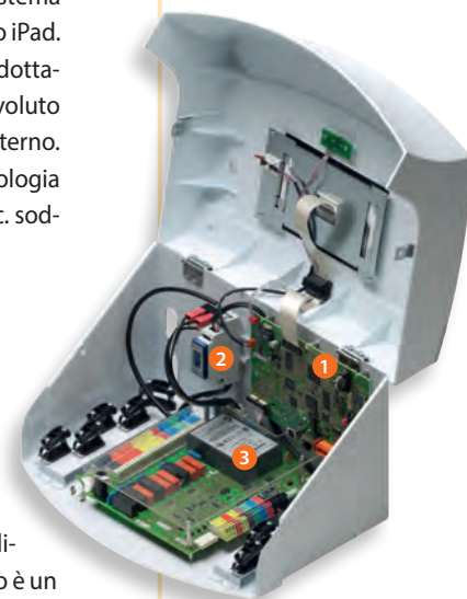
▼ Sistema di gestione energetica con coperchio aperto 1 Scheda CPU SaiaPCD® standard 2 Contatore di energia monofase 3 SBC Scheda I/O Vaillant
