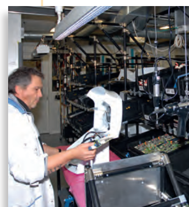
▲ Linea di montaggio del sistema di gestione energetica per il sistema di microcogenerazione Vaillant/Honda: sulla linea di produzione creata appositamente per questo prodotto, le schede SBC vengono montate e testate secondo metodi Lean.
