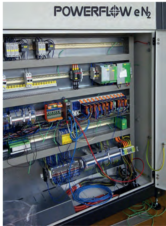
▲ Powerflow eN 2 Saldatrici compatte a onda con tunnel di inertizzazione ad azoto su tutto il processo caldo con Saia PCD®
