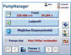
▲ KSB PumpManager basato sui SaiaPCD® Funzionali è anche liberamente programmabile con Step7 di Siemens.
