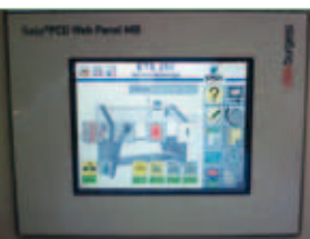
5,7"-Saia®PCD Web Panel MB. Het Web Panel maakt het mogelijk om de machine in het netwerk van de firma te integreren.
