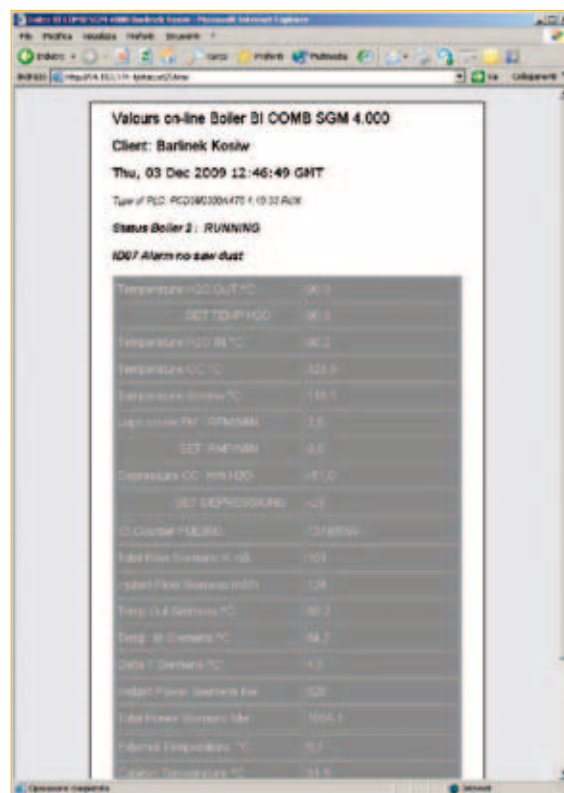
Boilerstatus via browserinterface op afstand opvragen. HMI-toepassing in webserver van de Saia®PCD3.WAC
