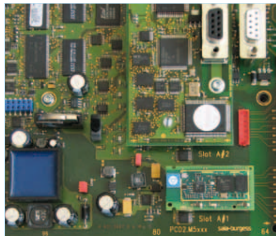
Saia®PCD7.F160S module op steekplaat A van een Saia®PCD2.M5
