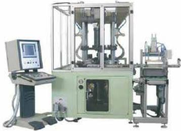
« Mythos » est une presse volumétrique à froid. Plus de 10 axes sont pilotés par un seul automate PCD2 équipé de modules de positionnement synchronisé PCD2.H32x.
