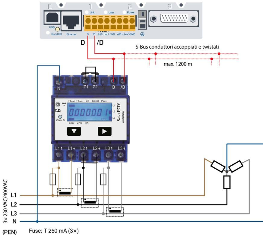
**!** Il collegamento secondario del trasformatore amperometrico, sul lato alimentazione, va collegato alla fase da misurare e quindi il trasformatore non deve essere messo a terra.
