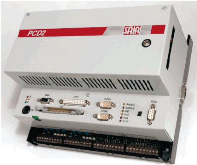
PCD2.M250 mit integriertem PC
