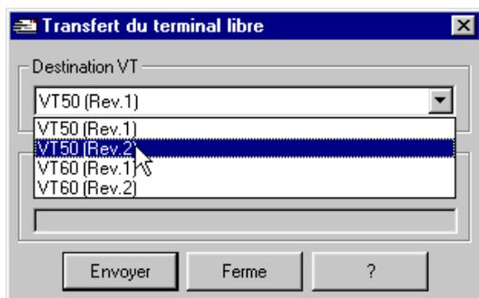
Sélectionner toujours *VT50 ( Rev.2)* si le terminal est un *PCD7.D790 (Rev.1 ou Rev.2)* ou *VT60 (Rev.2)* s'il s'agit d'un *D795 (Rev.1 ou Rev.2)*.
