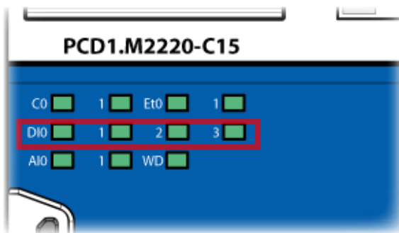
LEDs zu den digital Eingängen DI0 bis DI3
