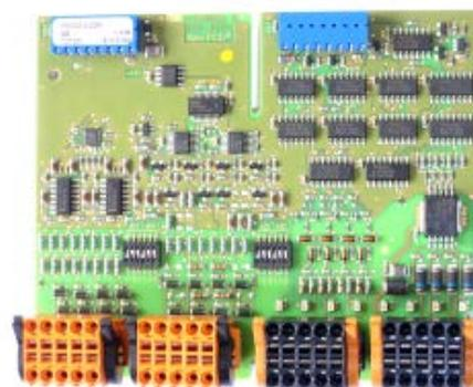
PCD2.G200 è un modulo di I/O multifunzione doppio, che può essere usato sia nel PCD1.M2xxx sia nel PCD2.M5xxx. Il modulo utilizza due slot di I/O.
