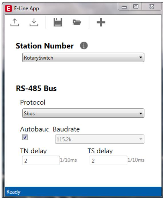
Le numéro de station peut être choisi dans une plage comprise entre 0 et 98 avec les commutateurs rotatifs sur l'équipement. Lorsque les commutateurs rotatifs indiquent 99 comme numéro de station, ce numéro de station peut être fixé par la configuration de l'équipement dans une plage comprise entre 0 et 253.
