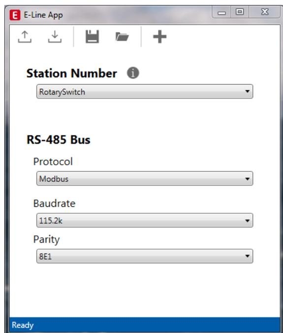
Par défaut, la vitesse de communication (*Baudrate*) est fixée à 115 k. Ce réglage peut être modifié à partir du menu déroulant.
