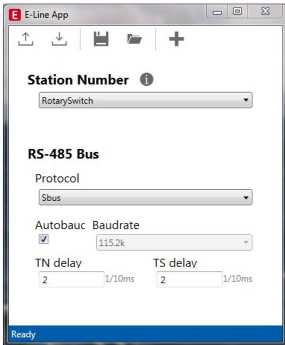
Il numero della stazione può essere impostato con i commutatori rotanti sul dispositivo nell'intervallo 0 ... 98. Se i commutatori rotanti sono impostati per posizionarsi su 99, il numero della stazione può essere definito con una configurazione del dispositivo nell'intervallo di 0 ... 253.
