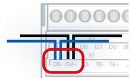
I cavi RS-485 flessibili con sezione non superiore a 0,75 mm<sup>2</sup> devono essere utilizzati per il cablaggio del bus. Per ciascun terminale è consentita una sezione del cavo di 1,5 mm<sup>2</sup>.
