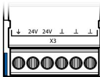
Für die Busverdrahtung sind flexible RS-485 Kabel mit maximal 0.75 mm<sup>2</sup> Querschnitt zulässig. Gesamthaft gilt ein Kabelquerschnitt von 1.5 mm<sup>2</sup> pro Klemme.
