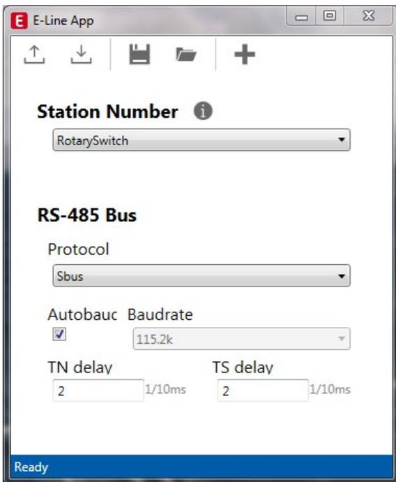
Die Stationsnummer wird mit den Drehschaltern am Gerät in einem Bereich von 0 ... 98 eingestellt. Werden die Drehschalter auf Position 99 gestellt, kann die Stationsnummer durch die Gerätekonfiguration in einem Bereich von 0 ... 253 definiert werden.
