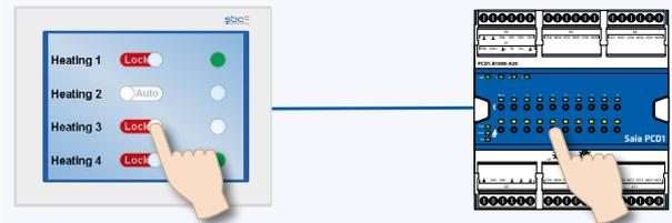
Mit der lokalen Vorrangbedienebene kann die Inbetriebnahme unabhängig von der Masterstation erfolgen. Zusätzlich lässt sich die Handbedienebene auch aus der Ferne über ein Touch Panel steuern. Wird die Busleitung getrennt, behält das Modul die eingestellten Handwerte. Traditionelle Handbedienebenen in der Schaltschranktür über Potentiometer und Schalter können damit vollständig ersetzt werden.
