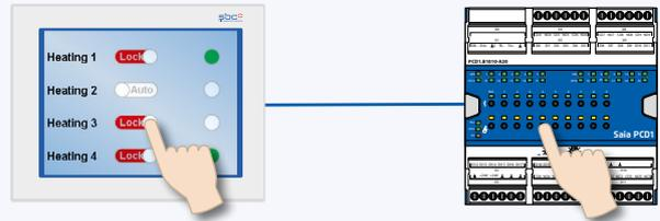
Impiegando la funzione di forzatura locale, la messa in esercizio può avere luogo indipendentemente dalla stazione master. Inoltre, il funzionamento manuale può anche essere controllato in remoto impiegando un touch-panel. Se la linea bus è interrotta, il modulo mantiene i valori impostati manualmente. Il funzionamento manuale tradizionale nello sportello del quadro di comando tramite potenziometri e commutatori può pertanto essere completamente sostituito da questa soluzione.
