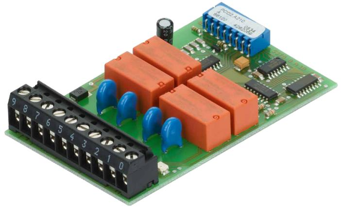
4 Relais mit Öffnerkontakten für Gleich- und Wechselspannung bis 2 A, 250 VAC sind im Modul untergebracht. Die Kontakte sind mit einem Varistor geschützt. Das Modul eignet sich vor allem dort, wo vollkommen getrennte Wechselstrom-Schaltkreise bei geringer Schalthäufigkeit gesteuert werden müssen.
