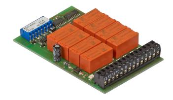
Le module comprend 8 relais avec contacts travail pour tension continue et alternative jusqu'à 2 A, 48 VCA. Le module convient tout particulièrement lorsque des circuits de courant alternatif avec une fréquence de commutation faible doivent être contrôlés. Pour des raisons de place, il n'y a pas de protection des contacts intégrée.
