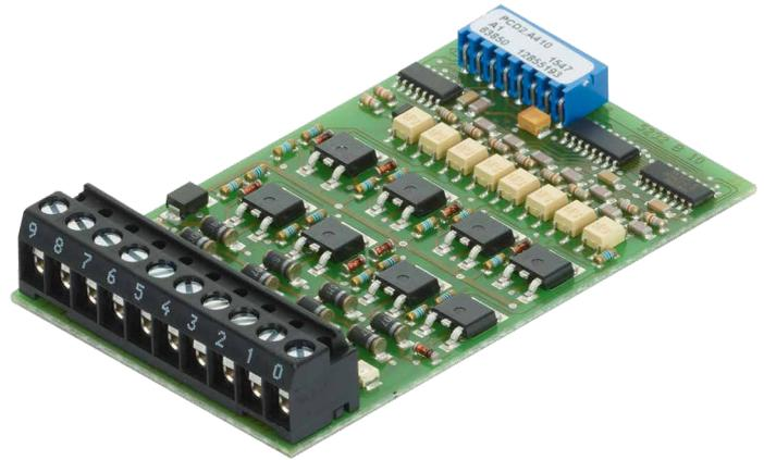
Galvanisch von der CPU getrenntes Ausgangsmodul mit 8 MOSFET-Transistorausgängen ohne Kurzschlussschutz.
