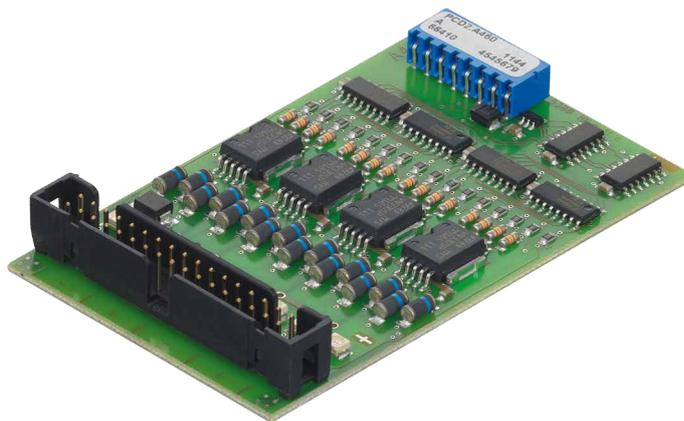
Modulo di uscita a basso costo con 16 uscite a transistor 5 ... 500 mA, con protezione contro i cortocircuiti. I singoli circuiti sono senza separazione galvanica, e la gamma di tensione è compresa fra 10 e 32 VCC.
