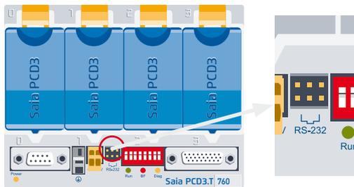
Permette di eseguire la configurazione con un browser quale Internet Explorer o (con cavo di collegamento PCD3.K225)
