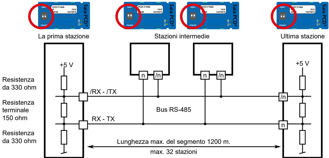
Die beiden Enden des Netzkabels müssen mit den Abschlusswiderständen terminiert/abgeschlossen, heisst auf «close», geschaltet sein.
