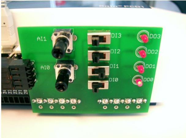
Jetzt kann mit dem Schalter DI0 der digitale Ausgang DO0 geschaltet werden
