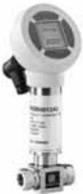
Die mikroprozessorunterstützten Differenzdrucktransmitter messen Differenzdrücke von 0 ... 20 bar. Sie sind bestens geeignet für vielfältige Einsatzbereiche, u. a. zur genauen Erfassung und Überwachung von Systemdrücken. Der M12x1 Winkelstecker ist im Lieferumfang enthalten. Der druckseitige Anschluß erfolgt über zwei G1/2" Innengewinde. Es sind sowohl 2- als auch 3-Leiter-Versionen erhältlich.
