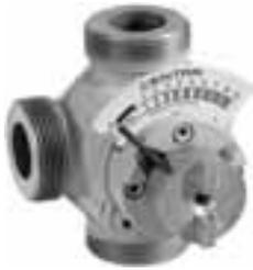
Heizungsmischer mit rundum vertauschbaren Anschlüssen. Der Dreiwege-Mischer DRU ist eine Weiterentwicklung der jahrzehntelang bewährten Mischertypen DR..G..A und DR..A. Er zeichnet sich insbesondere durch seine flexible Einbauweise aus, denn es kann durch einfaches Einstellen des Drehschiebers sowohl ein gerader (Werkeinstellung) als auch ein abgewinkelter Durchgang hergestellt werden. Wärmedämmschalen gehören zum Lieferumfang.
