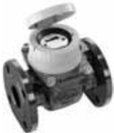
Honeywell EW170 Serie Woltman Wasserzähler werden zur Volumenmessung in Warm- und Kaltwassernetzen eingesetzt. EW170xA (d.h. EW1700A und EW1701A) Wasserzähler haben einen mechanisches Drehzählwerk und können mit bis zu zwei Reedschalter ausgestattet werden. EW170xB (d.h. EW1700B und EW1701B) Wasserzähler haben eine einen elektronischen Zähler sowie einen M-Bus und einen optischen ZVEI Ausgang.
