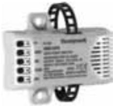
Dieser Frühwarn- Taupunktwärter ist zur Überwachung des Taupunktes von Kühlwasserrohren oder gekühlten Oberflächen entworfen worden. Die Befestigung ist an flachen und runden Oberflächen möglich. Der Schalter misst die relative Luftfeuchtigkeit direkt an der gekühlten Oberfläche und kann verwendet werden zum:
