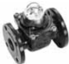
Honeywell EW457 Serie mechanische Durchflussmesser werden zur Durchflussmessung von Heizungswasser in Hydraulischen Heizsystemen verwendet. Sie werden typischerweise mit der Energiekalkulator Serie EW545 eingesetzt. Die Kombination von Durchflussmesser und Energiekalkulator hat die gleiche Funktionalität wie ein Wärmehzähler. EW457 Serie Durchflussmesser sind mit einem Reedschalter für einen Energiekalkulator ausgerüstet.
