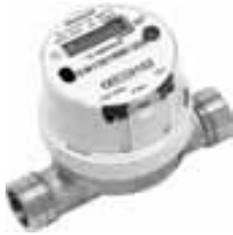
Honeywell EW130 Serie Multijet Wasserzähler werden zur Volumenmessung in Warm- und Kaltwassernetzen eingesetzt. Sie sind in den Nennweiten DN15 bis DN40 verfügbar und haben einen elektronischen Zähler mit optischer Schnittstelle und M-Bus. EW1300 Wasserzähler sind für Kaltwasser bis 30°C geeignet EW1301 Wasserzähler sind für Warmwasser bis 90°C geeignet. Messung von Warm- und Kaltwasser.
