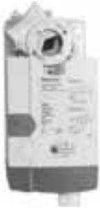
Drehantrieb mit Synchronmotor für Steckmontage zur stetigen Regelung von Luftklappen. 3-Pkt.-Varianten auch für AUF/ZU-Ansteuerung geeignet. Entriegelungstaste für manuelle Klappenbetätigung.
