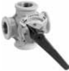
Heizungsmischer mit rundum vertauschbaren Anschlüssen. Der Vierwege-Mischer ZR ist eine solide Vierwege-Mischarmatur aus hochwertigem Armaturen-Grauguss GG 20 mit Regelkurve im verchromten Zylinderküken (DBP und Auslandspatente), dadurch lineare Temperaturcharakteristik im Heizungsvorlauf und Rücklaufanhebung zur Verhinderung der Kesselkorrosion. Die Mischer werden werkseitig mit Einstellung auf Kesselvorlauf von links geliefert. Umstellung durch einfaches Drehen der Mischerwelle.
