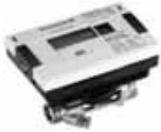
Statischer kompakter Wasserzähler mit elektronischer Messeinrichtung auf Ultraschallmessprinzip, bestehend aus elektronischem Rechenwerk, Ultraschall-Durchflussmesser und Temperatursensoren. Messung von Heiz- und/oder Kühlenergie in wasserführenden Systemen basierend auf Volumenstrom und Temperaturdifferenz.
