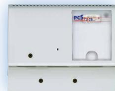
Eine PCS1-Steuerung ist frei programmierbar. Die integrierten Datenpunkte sowie Kommunikationsschnittstellen sind auf HLK-Anwendungen abgestimmt. Sie stehen den Anwenderprogrammen mittels Funktionsbausteinen (FBoxen) zur Verfügung.
