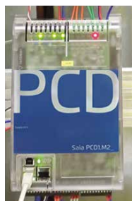
Einsatz als Kommunikations-Schnittstelle mit M-Bus in einem Fernwärmenetz
