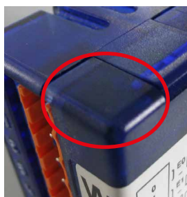
Vecchi moduli senza possibilità di fissaggio
