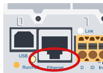
Connessione Ethernet senza LED
