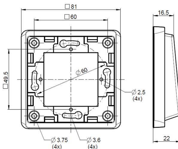
Les vis doivent être serrées au maximum à 0,6 Nm
